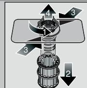
Rodar o filtro cilíndrico
