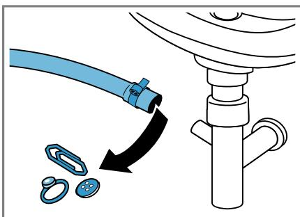
5. Enfichez le tuyau d'évacuation d'eau et sécurisez le point de raccordement à l'aide du collier de serrage.
