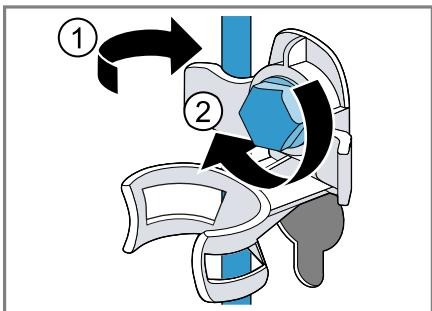
5. Insérez le tuyau dans le support.
