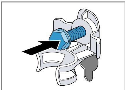
4. Fixez le cordon d'alimentation secteur dans le support ① et serrez les 4 vis des verrous de transport à l'aide d'une clé à vis de calibre 13 ②.
