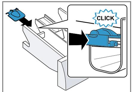
4. Die Waschmittelschublade einsetzen.
