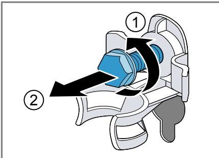
3. Die Netzanschlussleitung aus der Halterung ziehen.
