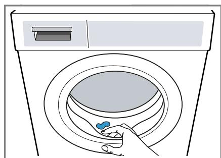
4. Die Tür und die Waschmittelschublade offen lassen, damit Restwasser abtrocknen kann.
