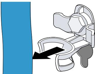
2. Alle Schrauben der 4 Transportsicherungen mit einem Schraubenschlüssel SW13 lösen ① und entfernen ②.
