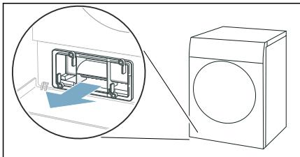
4. Eliminer toutes les peluches du couvercle de l'échangeur thermique et du filtre à peluches.
