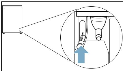
**5.** Poussez le tuyau d'évacuation jusqu'en butée sur le manchon dénudé.
