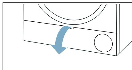
2. Déverrouillez le levier du couvercle de l'échangeur thermique.
