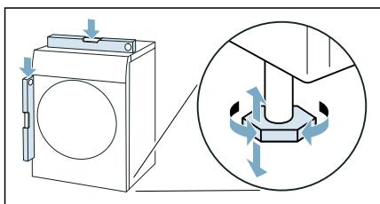
3. Si nécessaire, réalignez l'appareil en tournant les pieds de l'appareil.
