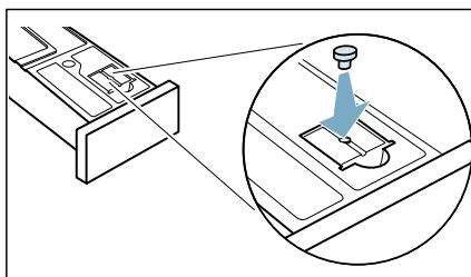
**10.** Poussez le réservoir d'eau de condensation jusqu'à ce qu'il s'enclenche.
