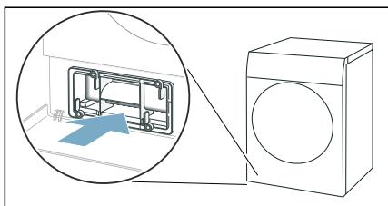
**Remarque :** Vous pouvez insérer le couvercle de l'échangeur thermique uniquement lorsque le dépôt à peluches se trouve dans l'appareil.
