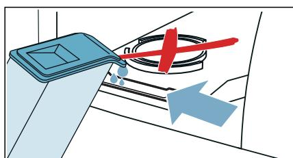
**Remarque :** Si vous versez plus de 180 ml d'eau potable dans l'appareil et que ☑ ne disparaît pas de l'affichage, vous n'avez pas versé l'eau potable dans le bon orifice ou l'appareil n'a pas été correctement aligné. Versez l'eau potable par l'orifice de remplissage avant ou alignez correctement l'appareil.
