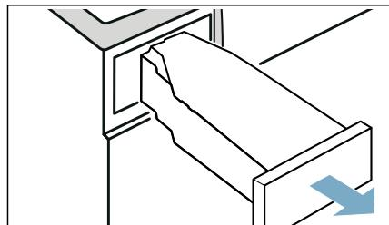
6. Versez env. 180 ml d'eau froide potable à l'aide de la verseuse fournie dans l'orifice de remplissage **avant** de l'appareil jusqu'à ce que ☑ disparaisse et qu'un signal retentisse.
