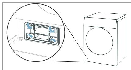
3. Retirez le couvercle de l'échangeur thermique sur la poignée.
