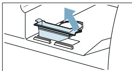
3. Mettez le filtre en place dans le réservoir d'eau.
