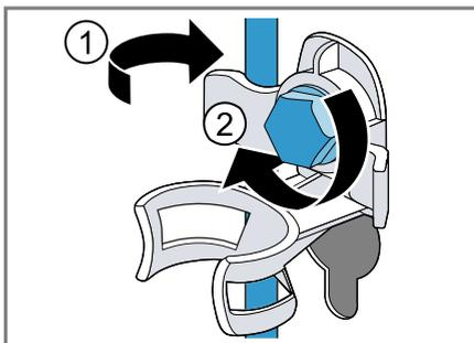
5. Insérez le tuyau dans le support.
