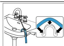
Évacuation dans un tuyau en PVC avec manchon en caoutchouc.
