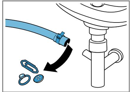
5. Colocar la manguera de evacuación en el sifón y asegurar el punto de conexión apretando la abrazadera.
