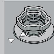
kierrä siiviläjärjestelmä kiinni. HUOMIOI MERKIT!
