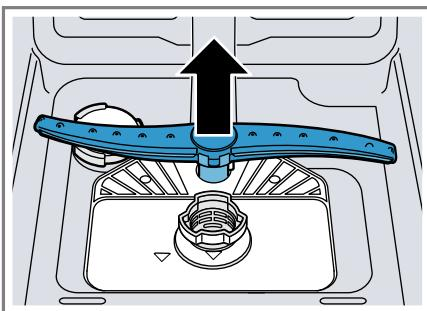
3. Pod tekoucí vodou zkobtrolujte, zda nejsou ucpané výstupní trysky ostříkovacích ramen a popř. odstraňte cizí tělesa.
