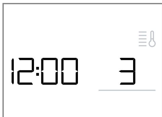
Una vez iniciado el funcionamiento, el termómetro se ilumina y las barras colindantes se completan para indicar el progreso de calentamiento de la temperatura de la cavidad interior. Cuando todas las barras están completas, el aparato se calienta. Cuando se asa al grill, las barras se completan inmediatamente.
