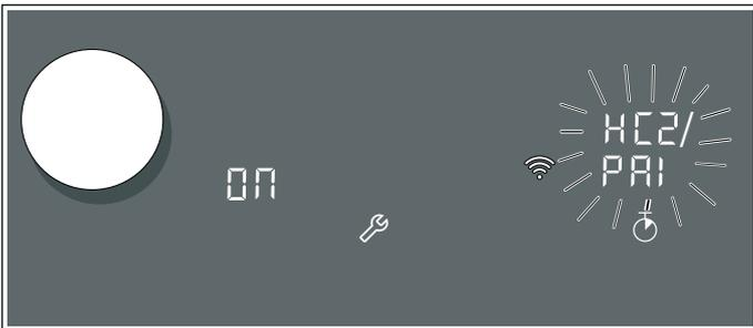
Das Gerät versucht automatisch, sich mit der App zu verbinden. Im Einstellbereich blinken abwechselnd *HC2* und *PRI*. In der Kochstellenanzeige blinkt der Wert *ON*.
