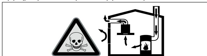
Εστίες, εξαρτημένες από τον αέρα του περιβάλλοντος (π.χ. συσκευές θέρμανσης που λειτουργούν με αέριο, πετρέλαιο, ξύλο ή άνθρακα, ταχυθερμοσίφωνες, θερμαντήρες νερού) λαμβάνουν τον αέρα για καύση από το χώρο τοποθέτησης και οδηγούν τα καυσαέρια μέσα από μια εγκατάσταση απαγωγής των καυσαέριων (π.χ. καμινάδα) στον έξω χώρο.
