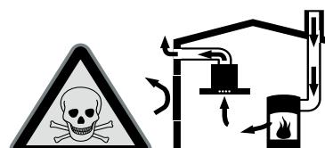
Eldstäder som är beroende av rumsluft (t.ex. värmearrapparater som drivas med gas, olja, ved eller kol, genomströmningsapparater, varmvattenberedare) tar sin förbränningsslut ur det utrymme där enheten är installerad och leder ut avgaserna i det fria via en avgasanläggning (t.ex. skorsten).
