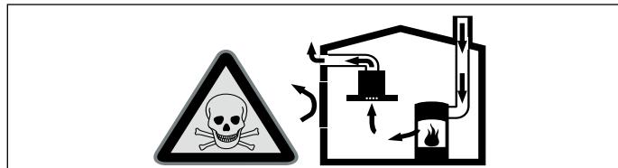
Zależne od powietrza w pomieszczeniu urządzenia spalające (np. grzejniki na gaz, olej, drewno lub węgiel, przepływowie podgrzewacze wody i inne podgrzewacze wody) pobierają powietrze do spalania z pomieszczenia, w którym się znajdują, a spaliny odprowadzają przez układ wylotowy (np. komin) na zewnątrz.
