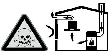
Huoneilmaa tarvitsevat tulisijat (esim. kaasu-, öljy-, puu- tai hiilikäyttöiset lämmityslaitteet, läpivirtauskuumennin, vedenkuumennin) ottavat poistoilman huonetilasta ja johtavat poistoilman poistoilmalaitteen (esim. savutorven) kautta ulos. Tuuletin imkeelee keittiöstä ja sen viereisistä huoneista ilmaa - tämä on korvattava riittäväällä tuloilmallla - muutoin syntyy alipaine. Myrkylliset kaasut imetyisivät takaisin huoneisiin savutorvesta tai poistoilmakanavasta.
