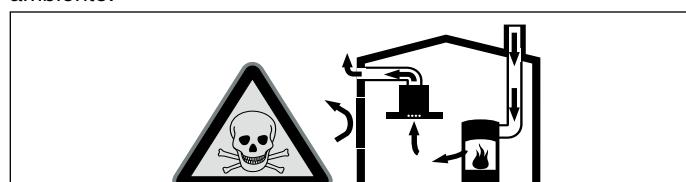
I focolari che dipendono dall'aria ambiente (per es. a gas, olio, legna o carbone, scaldabagno, caldaie elettriche) ricavano l'aria per la combustione dalla stanza ed eliminano i gas di scarico all'esterno attraverso un impianto (per es. camino).
