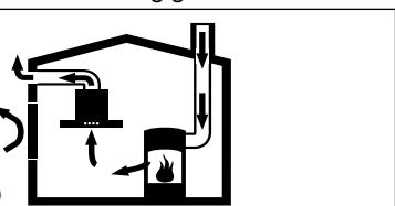
Ildsteder som er avhengig av romluft (f.eks. varmeapparater som drives med gass, olje eller kull, varmtvannsberedere) bruker forbrenningsluften fra oppstillingsrommet og leder avgassene gjennom et avgassanlegg (f.eks. pipe) i det fri.
