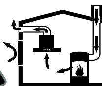
Ildsteder, hvis lufttilførsel sker fra indeluften, (f.eks. gas-, olie-, træ- eller kulfyrede varmeapparater, gennemstrømningsvandvarmere, vandvarmere) henter deres forbrændingsluft fra opstillingsrummet og fører røggassen ud gennem en røggaskanal(f.eks. skorsten) til det fri.
