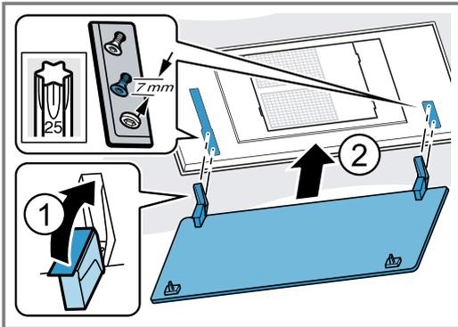
2. Die Filterabdeckung an den vorgesehenen Schrauben einhängen und je nach Schlüssellochöffnung nach hinten/vorne in die Engstelle schieben.
