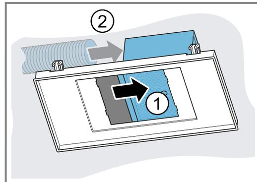
7. Den Lüfterkasten mittig positionieren und festschrauben.
