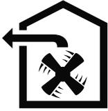
Die Luft darf nicht in einen Kamin abgeleitet werden, der für Abgase von Geräten verwendet wird, die Gas oder andere Brennstoffe verbrennen (dies gilt nicht für Umluftgeräte).
