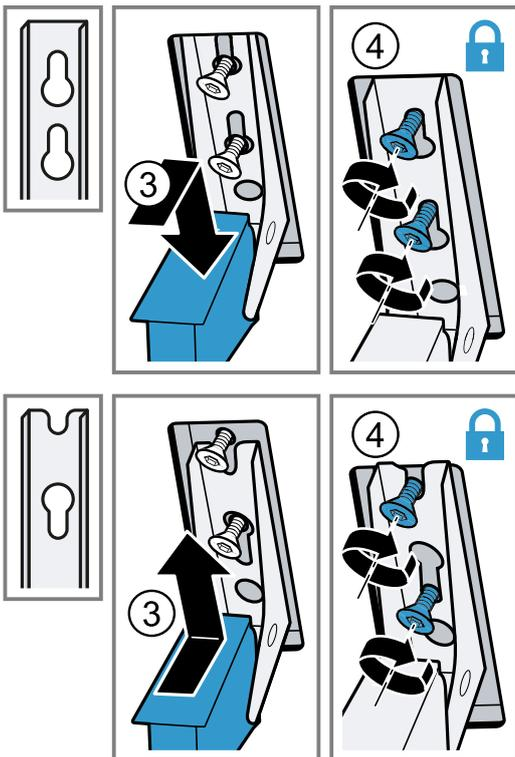
3. Die Befestigungsschrauben der Scharniere festziehen.
