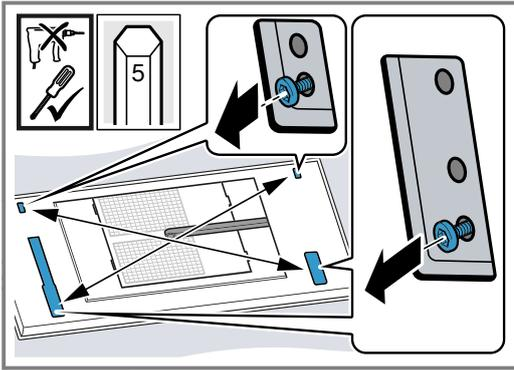
Die Schrauben nicht vollständig lösen.
