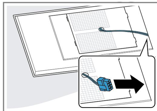
9. Den Kabelkanal zusammendrücken und aufsetzen.
