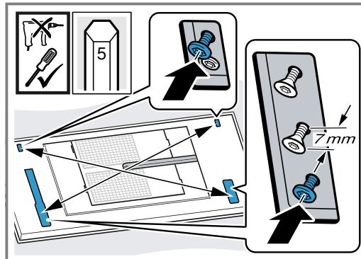
Om ervoor te zorgen dat het apparaat niet in de uitsparing kantelt, de schroeven een voor een aantrekken.
