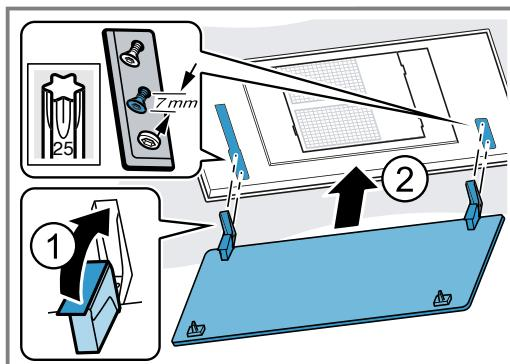
2. De filterafdekking aan de daarvoor bestemde schroeven inhangen en afhankelijk van de sleutelgatopening naar achteren/voren in de nauwe opening schuiven.
