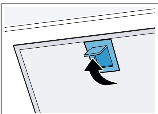
**4. Retirez les filtres à graisse des fixations.**
