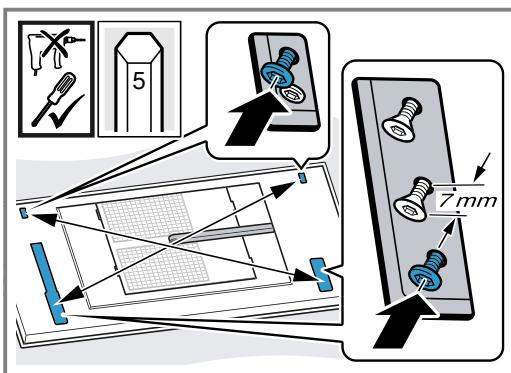
Damit das Gerät nicht im Ausschnitt verkantet, die Schrauben stückweise anziehen.
