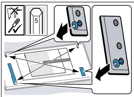
Die Schrauben nicht vollständig lösen.
