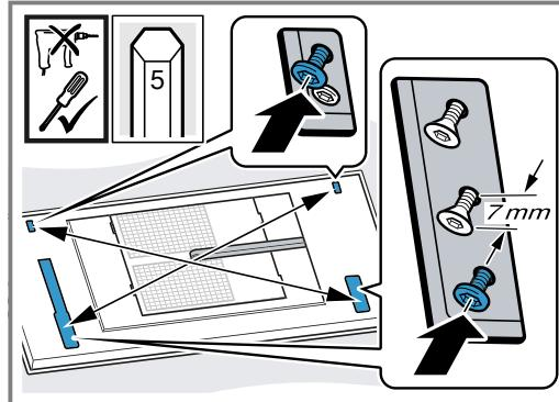
Vissez les vis une par une pour que l'appareil ne se déforme pas dans la découpe.
