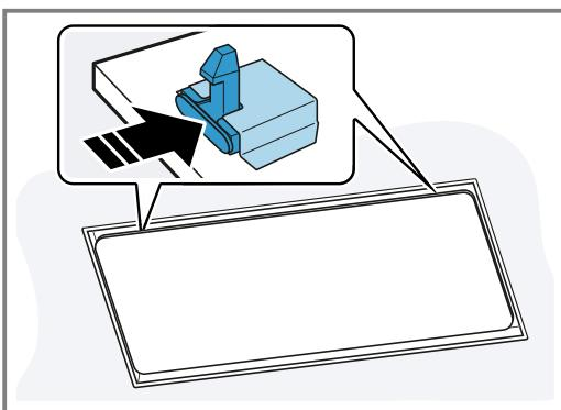
Um zu verhindern, dass die Filterabdeckung ruckartig nach unten klappt, die Filterabdeckung mit zwei Händen festhalten.
