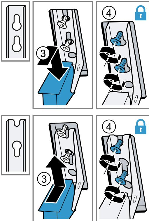
3. De bevestigingsschroeven van de scharnieren aantrekken.
