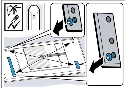
No aflojar completamente los tornillos.
