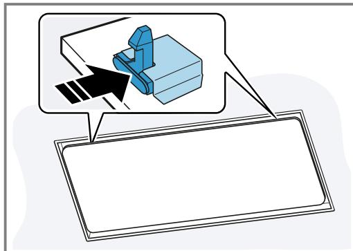
Para evitar que a tampa do filtro rebata bruscamente para baixo, segure na tampa do filtro com as duas mãos.
