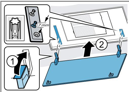
**2. Engate a tampa do filtro nos parafusos previstos e, consoante o orifício da chave, empurre-a para trás/ para a frente, para dentro da secção estreita.**
