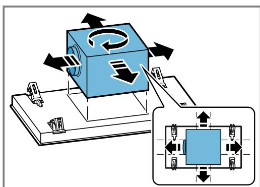
5. Deslizar la caja del ventilador hacia un lado y conectar el aparato a la red eléctrica.
