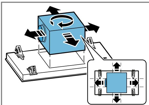
5. Empurre a caixa do ventilador para o lado e ligue o aparelho à corrente.
