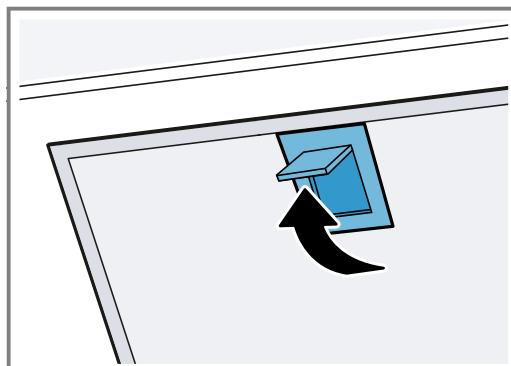
4. Retirar los filtros antigrasa de las sujetaciones. Sujetar los filtros antigrasa en posición horizontal para evitar que la grasa gotee.
