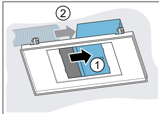
7. Posicione a caixa do ventilador ao centro e fixe-a.
