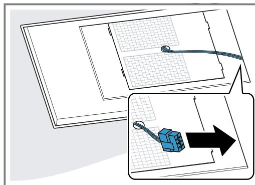
9. Presionar lateralmente el conducto del cableado y colocarlo.
