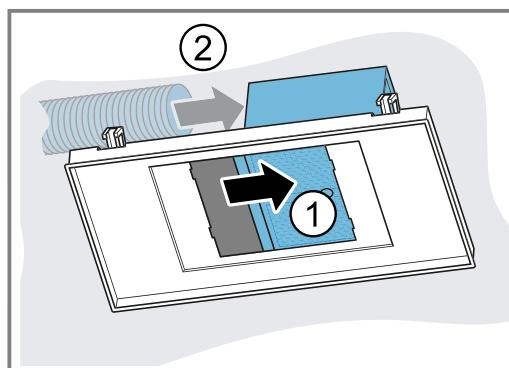
7. Colocar la caja del ventilador en el centro y atornillar.
