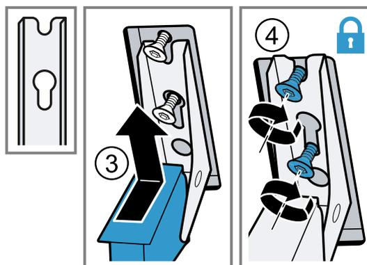
3. Die Befestigungsschrauben der Scharniere festziehen.
