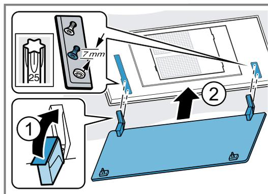
2. Die Filterabdeckung an den vorgesehenen Schrauben einhängen und je nach Schlüssellochöffnung nach hinten/vorne in die Engstelle schieben.
