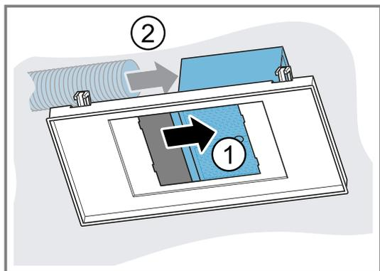
7. Den Lüfterkasten mittig positionieren und festschrauben.
