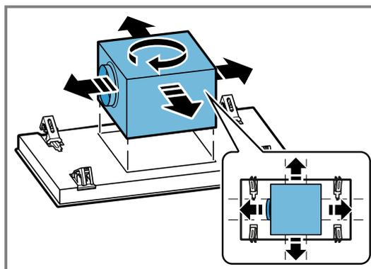
5. Den Lüfterkasten auf die Seite schieben und das Gerät mit dem Stromnetz verbinden.
