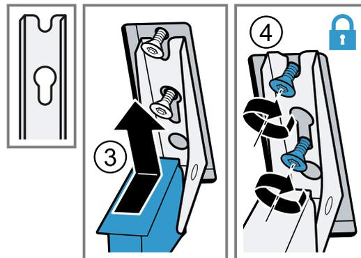
3. Die Befestigungsschrauben der Scharniere festziehen.
