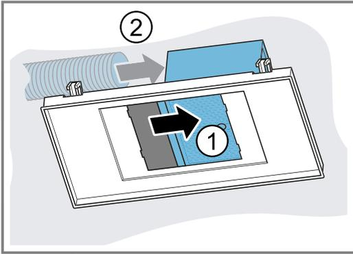
7. Den Lüfterkasten mittig positionieren und festschrauben.
