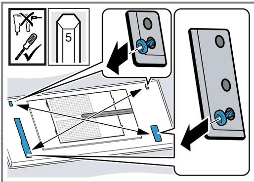
Die Schrauben nicht vollständig lösen.
