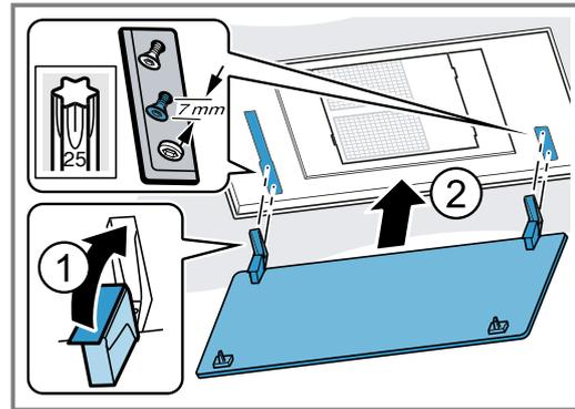
2. Die Filterabdeckung an den vorgesehenen Schrauben einhängen und je nach Schlüsselöffnung nach hinten/vorne in die Engstelle schieben.
