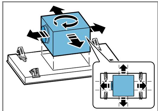
5. Den Lüfterkasten auf die Seite schieben und das Gerät mit dem Stromnetz verbinden.
