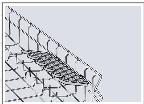
Výšku etažéru můžete nastavit.<sup>1</sup> Pokud etažér nepotřebujete, můžete ho sklopit nahoru.
