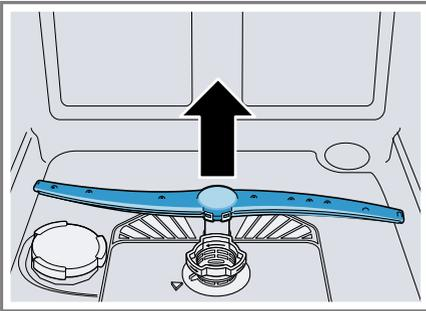
3. Під проточною водою перевірте, чи не засмічено випускні сопла розпилювальних коромисел; за потреби приберіть звідти сторонні предмети.
