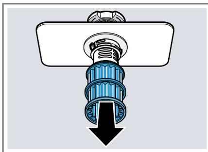
4. Стисніть фіксатори ① і вийміть фільтр грубого очищення вгору ②.
