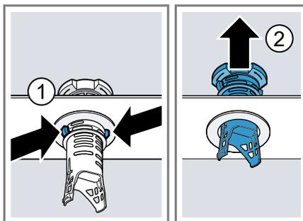
5. Промийте фільтрувальні елементи під проточною водою. Ретельно приберіть смужку бруду між фільтрами грубого й тонкого очищення.
