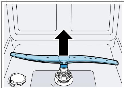
2. Proverite da li na izlaznim mlaznicama prskalice ima začepljenja tako što ćete ih postaviti pod mlaz tekuće vode i po potrebi ukloniti strana tela.
