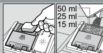
Rengjøringsmiddel må på i det tørre kammeret for rengjøringsmiddel.
