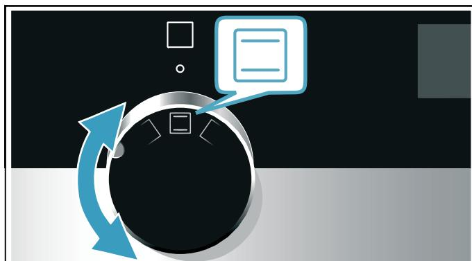
2. За допомогою регулятора температури встановіть температуру або режим гриля.
