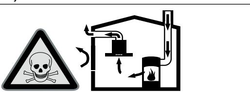
Grijala na plamen koja ovise o zraku iz prostorije (npr. plinska grijala, grijala na ulje i drva ili ugljen, protočni grijaci vode, uređaji za pripremu tople vode) troše zrak za sagorijevanje iz prostorije u kojoj je postavljen uređaj i odvode dimne plinove kroz dimovodne uređaje (npr. dimnjak) na otvoreno.
