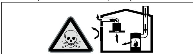
Vatrišta koja zavise od vazduha u prostoriji (npr. grejni uređaji na gas, ulje, drvo ili ugaj, protocni bojleri, kotlovi za zagrevanje vode) vazduh za sagorevanje crpe iz prostorije u koju su postavljeni i izdunve gasove izbacuju preko sistema za izdunve gasove (npr. kamoin) u spoljašnju sredinu.
