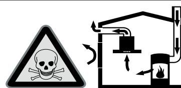
Kurišča, odvisna od zraka v prostoru (npr. grelne naprave na plin, olje, les ali premog, pretočni grelniki, bojlerji) črpajo zrak za izgorevanje iz prostora, v katerem so nameščeni, in odvajajo izpušne pline prek sistema za odvajanje plinov (npr. dimnika) na prosto.
