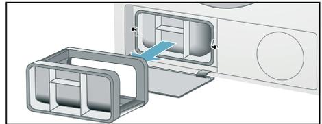
5. Entnehmen Sie den Wärmetauscher.
