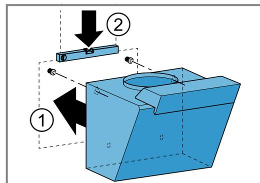
12. Die Bohrung für die Sicherungsschraube anzeichnen.
