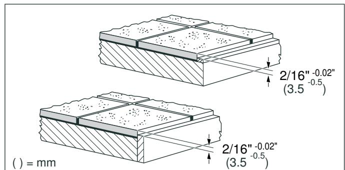
**Pose en affleurement:** L'appareil peut être encastré dans des plans de travail résistant à la chaleur et à l'eau, fabriqués dans les matériaux suivants :
