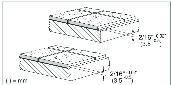
**Montaje a ras de superficie:** El aparato se puede montar en las siguientes encimeras resistentes a la temperatura y al agua:
