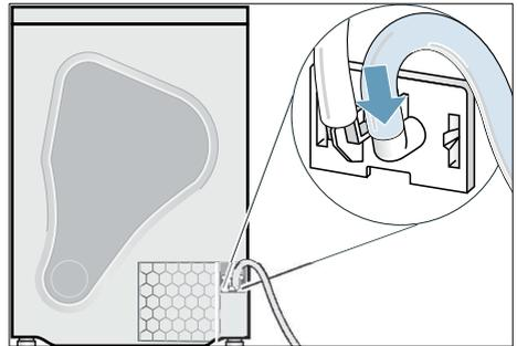
6. Befestigen Sie den Ablaufschlauch mit der anderen Seite je nach Anschluss-Situation A, B oder C mit dem restlichen Zubehör.
