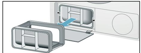
5. Entnehmen Sie den Wärmetauscher.
