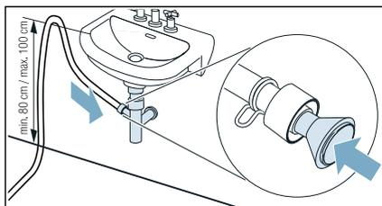
Le point de raccordement doit être fixé par un collier de serrage (plage de serrage 12-22 mm, commerce spécialisé).
