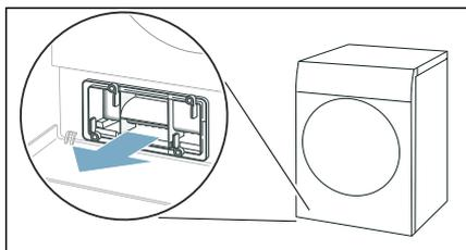
5. Retirez le matelas filtrant avec précaution du couvercle de l'échangeur thermique.
