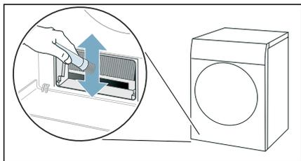
**Remarque :** Veillez à nettoyer les lamelles de l'échangeur thermique du haut vers le bas, et à ne pas les plier ni les endommager.
