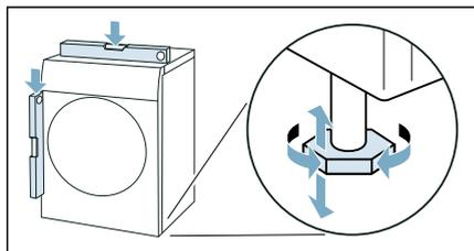
3. Si nécessaire, réalignez l'appareil en tournant les pieds de l'appareil. Vous pouvez à présent raccorder l'appareil.
