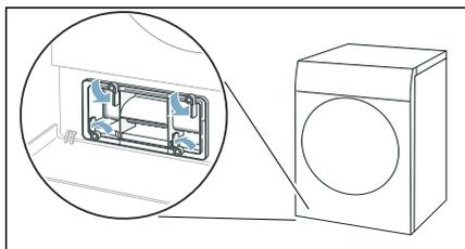
4. Retirez le couvercle de l'échangeur thermique sur la poignée.
