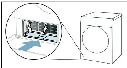
10. Insérez le couvercle de l'échangeur thermique à la poignée.
