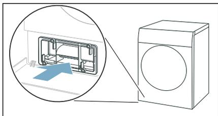
**Remarque :** Vous pouvez uniquement insérer le couvercle de l'échangeur thermique lorsque l'insert se trouve dans l'appareil.
