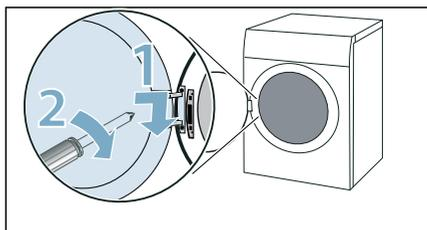
18. Ruotare di 180° la serratura dell'oblò e inserirla sull'altro lato.
