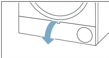
2. Sbloccare la leva del coperchio dello scambiatore di calore.
