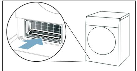
11. Inserire il coperchio dello scambiatore di calore sulla maniglia.
