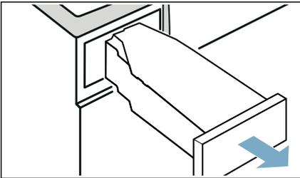
8. Versare circa 1 ½ un litro di acqua calda del rubinetto nel contenitore della condensa.
