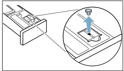
2. Ruotare il contenitore dell'acqua di condensa di 180° e capovolgerlo e inserire il tappo.
