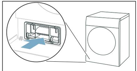
**Avvertenza:** È possibile inserire il coperchio dello scambiatore di calore soltanto il vano di deposito della lanugine si trova nell'apparecchio.
