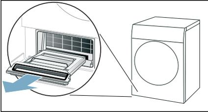
**Avvertenza:** Il vano di deposito della lanugine può contenere lanugine umida e acqua residua e può gocciolare durante l'estrazione.
