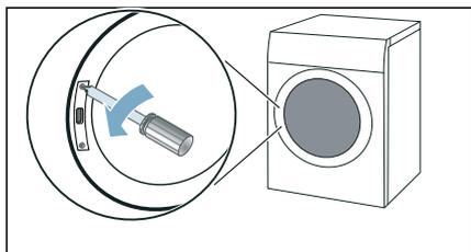
19. Avvitare la copertura della serratura dell'oblò.
