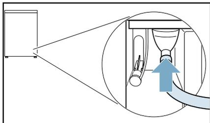
6. Fissare l'altro lato del tubo di scarico, a seconda della tipologia di allacciamento, con gli altri accessori.
