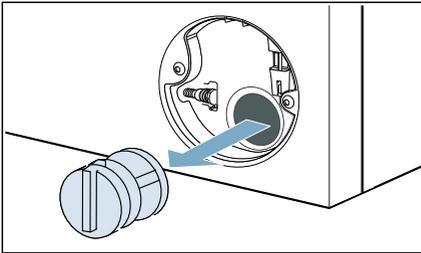
12. Innenraum, Gewinde des Pumpendeckels und Pumpengehäuse reinigen.
