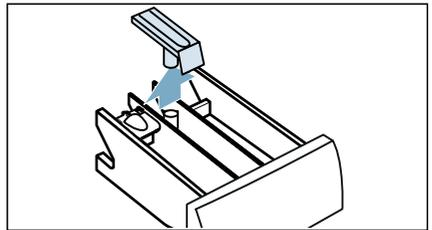
4. Einspülschale und Einsatz mit Wasser und Bürste reinigen. Anschließend abtrocknen.
