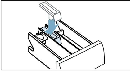
6. Gehäuse der Waschmittelschublade im Gerät reinigen.
