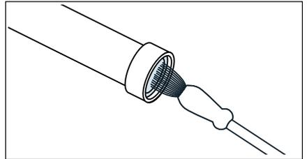
3. Schlauch anschließen und auf Dichtheit prüfen.
