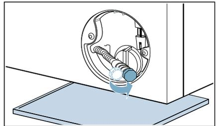
10. Entleerungsschlauch in die Halterung einsetzen.
