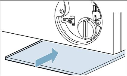
7. Entleerungsschlauch aus der Halterung nehmen.
