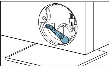
8. Verschlusskappe abziehen und Lauge in geeignetes Gefäß abfließen lassen.
