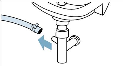
4. Ablaufschlauch und Siphon-Stutzen reinigen.
