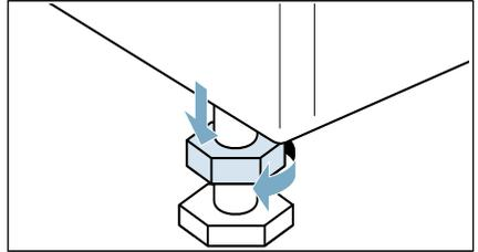
2. Gerät durch Drehen der Gerätefüße ausrichten. Ausrichtung mit Wasserwaage überprüfen.
