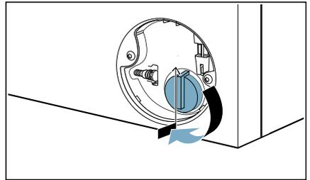
14. Serviceklappe einsetzen und einrasten.
