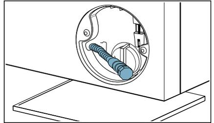
8. Verschlusskappe abziehen und Lauge in geeignetes Gefäß abfließen lassen.
