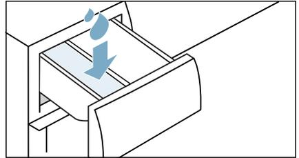
6. Pulvervollwaschmittel in die linke Kammer einfüllen.
