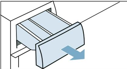
2. Einsatz herunterdrücken und Waschmittelschublade herausziehen.
