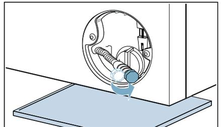
10. Entleerungsschlauch in die Halterung einsetzen.
