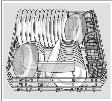
Chargez les assiettes et bols dans le panier inférieur en les faisant pencher vers l'avant.
