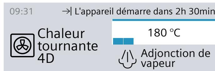
Le four est en position d'attente. Le symbole  $\rightarrow$  et l'heure à laquelle le fonctionnement sera terminé apparaissent dans la ligne d'état. Le fonctionnement démarre au moment approprié. La durée s'écoule visiblement dans la ligne d'état.
