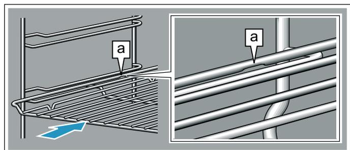
En introduisant des plaques, veillez à ce que l'encoche **a** soit à l'arrière et orientée vers le bas. La partie
