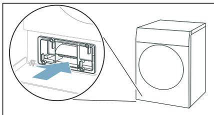
**Nota:** La cubierta del intercambiador de calor solo puede introducirse si la pieza insertada está en el aparato.
