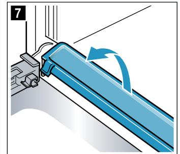
Reinigen Sie die Scheiben mit Glasreiniger und einem weichen Tuch. Wischen Sie die Kondensatleiste mit einem Tuch und heißer Spüllauge ab.
