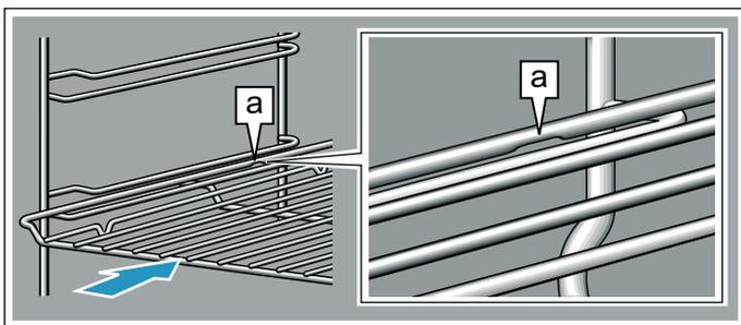
Achten Sie beim Einschieben von Blechen darauf, dass die Kerbe **a** hinten ist und nach unten zeigt. Die Abschrägung des Zubehörs **b** muss vorne zur Gerätetür zeigen.
