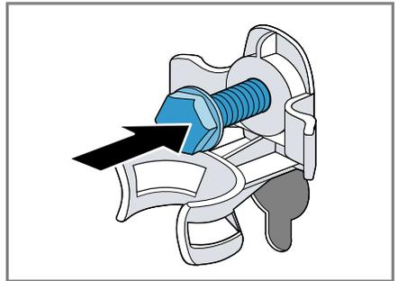
4. Die Netzanschlussleitung in die Halterung einsetzen ① und alle 4 Schrauben der Transportsicherungen mit einem Schraubenschlüssel SW13 festziehen ②.
