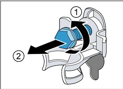
3. Die Netzanschlussleitung aus der Halterung ziehen.
