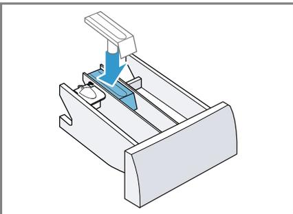
6. Die Öffnung für die Waschmittelschublade reinigen.
