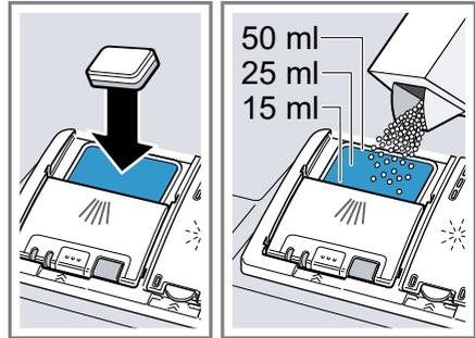
Une pastille suffit, le cas échéant. Déposez la pastille en diagonale. Si vous utilisez du détergent en poudre ou liquide, observez les indications de dosage du fabricant et la graduation du dosage du compartiment à détergent. 20 à 25 ml de détergent suffisent pour la vaisselle à souillure normale. Si la vaisselle est peu sale, une quantité de détergent légèrement inférieure à celle indiquée suffira habituellement.
