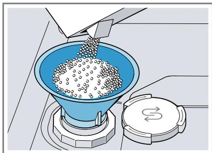
Remplissez complètement le réservoir de sel spécial. L'eau dans le réservoir est ainsi refoulée et s'écoule.
