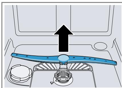
3. Proverite da li na izlaznim mlaznicama prskalica ima začepljenja tako što ćete ih postaviti pod mlaz tekuće vode i po potrebi uklonite strana tela.
