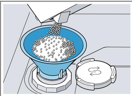
Remplissez complètement le réservoir de sel spécial. L'eau dans le réservoir est ainsi refoulée et s'écoule.
