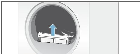
3. Retirez les peluches de la cavité du filtre à peluches.
