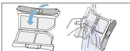
6. Séchez le filtre à peluches, fermez-le et réinsérez-le filtre à peluches.
