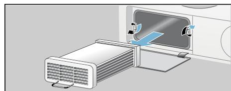
6. Faites couler de l'eau à travers l'échangeur thermique, de tous les côtés, pour retirer entièrement toutes les peluches.
