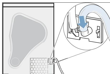
6. Fixez l'autre extrémité du tuyau d'évacuation avec les accessoires restants en fonction du type de branchement A, B ou C.
