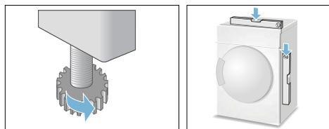
Un alignement incorrect peut engendrer de hauts niveaux de bruits, des vibrations et un mouvement incorrect du tambour.
