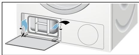
4. Retirez le couvercle supérieur de l'échangeur thermique.
