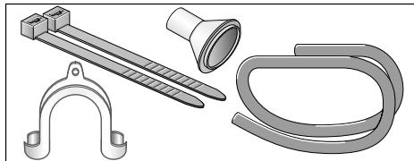
2. État de la livraison du sèche-linge : un tuyau est fixé au manchon pour l'évacuation de l'eau de condensation dans le réservoir d'eau de condensation.
