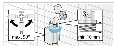
**Указание:** Отворете внимателно водопроводния кран, проверете за течове от точките на свързване. Винтовата връзка е под налягането на главния водопровод.
