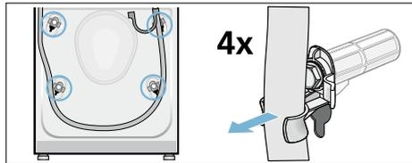
2. Netzleitung aus den Halterungen nehmen. Alle 4 Transportsicherungsschrauben lösen und entfernen. Hülsen entfernen.
