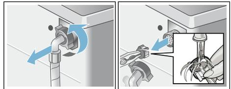
7. Sieb einsetzen, Schlauch anschließen und auf Lecks prüfen.
