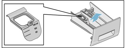
3. Einspülkammer und Einsatz mit Wasser und Bürste reinigen und abtrocknen. Auch Gehäuse innen reinigen.
