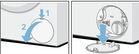
4. Entleerungsschlauch aus der Halterung nehmen. Verschlusskappe abziehen, Lauge in geeignetes Gefäß abfließen lassen.
