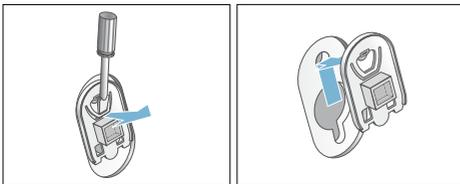
2. Alle 4 Hülsen einsetzen. Netzleitung an den Halterungen festklemmen. Schrauben einsetzen und festziehen.
