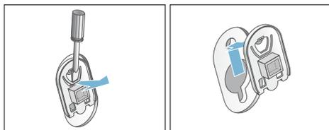
2. Insira as quatro mangas. Fixe o cabo de alimentação nos suportes, de forma segura. Insira e aperte os parafusos.
