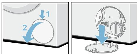
4. Retire a mangueira de escoamento do retentor. Remova a tampa de vedação e deite a água num recipiente adequado. Substitua a tampa de vedação e recolha a mangueira de escoamento no retentor.
