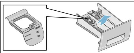
3. Limpe a gaveta para detergente e o dispositivo com água e uma escova, e seque-os. Limpe também o interior da caixa.
