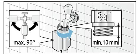
**Conselho:** Abra cuidadosamente a torneira, verificando a estanqueidade dos pontos de ligação. A união roscada está sob pressão da água da rede pública.
