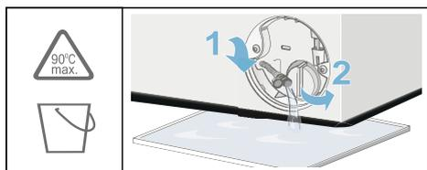
5. Desaparafuse cuidadosamente a cobertura da bomba; poderá sair água residual. Limpe o interior, a rosca da cobertura da bomba e o respetivo alojamento. O impulsor na bomba de escoamento tem de ser capaz de girar.
