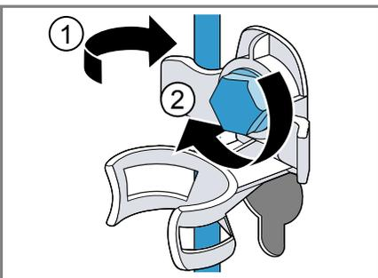
5. Insérez le tuyau dans le support.
