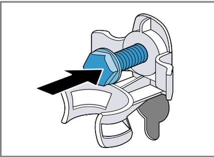
4. Fixez le cordon d'alimentation secteur dans le support ① et serrez les 4 vis des verrous de transport à l'aide d'une clé à vis de calibre 13 ②.
