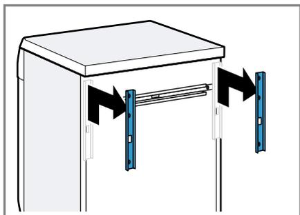
3. Desserrez et retirez les vis des sécurités de transport horizontales à l'aide d'un tournevis T20.
