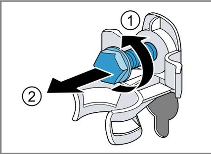
3. Die Netzanschlussleitung aus der Halterung ziehen.
