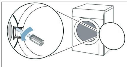
**Nota:** Utilizar únicamente un destornillador T20 (Torx) y ninguna otra herramienta para cambiar el sentido de apertura de la puerta.
