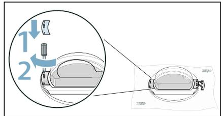
**Nota:** Asegurarse de no pillar o dañar la junta de la puerta al insertar el ojal.
