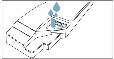
**Nota:** Mantener siempre en posición horizontal el recipiente de condensación lleno para que el líquido no se derrame.
