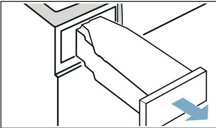
2. Vaciar el agua condensada.
