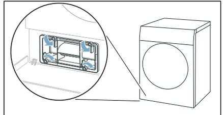
3. Extraer la cubierta del intercambiador de calor por el agarre.
