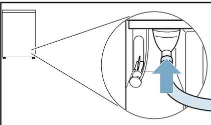
6. Fijar el otro extremo de la manguera de evacuación con el resto de accesorios según la situación de conexión.
