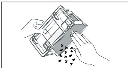
**Nota:** Asegurarse de que no quede ninguna suciedad en la junta ni en la cubierta del intercambiador térmico.
