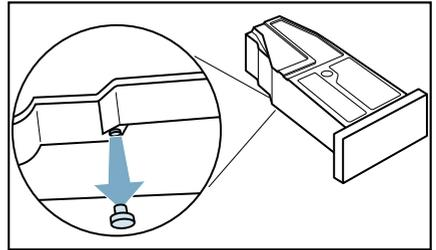
9. Volver a girar 180° el depósito de agua condensada y colocar el tapón en la zona profunda de la parte superior del recipiente para agua condensada.
