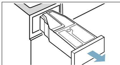
2. Vaciar el agua condensada.
