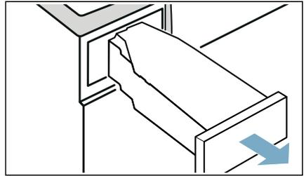
6. Verter 180 ml de agua potable fría con la jarra suministrada en la abertura de llenado **frontal** del aparato hasta que en el panel indicador se ilumine **Depósito para función vapor vacío Por favor, rellene** y suene una señal acústica.
