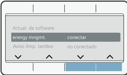
El aparato intenta conectarse con el Smart Energy System (gestor de energía). Si el aparato se ha conectado correctamente, en la pantalla aparece: **conectar**.
