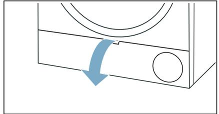
2. Desenclavar el tirador de la cubierta del intercambiador de calor.
