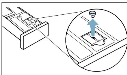
2. Girar el depósito de agua condensada 180° hasta dejarlo boca abajo y colocar el tapón.
