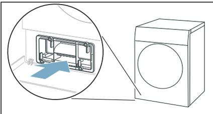
**Nota:** La cubierta del intercambiador térmico solo puede introducirse si el depósito de pelusas está en el aparato.
