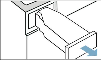
8. Colocar el recipiente para agua condensada y empujarlo hasta que quede bien encajado.
