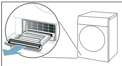
**Nota:** El depósito de pelusas puede contener pelusas húmedas, así como agua residual, y puede gotear al extraerlo.
