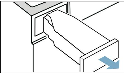
8. Girar el depósito de agua condensada 180° hasta dejarlo boca abajo y retirar el tapón que lleva.
