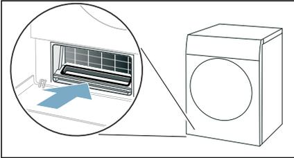
**11.** Introducir la cubierta del intercambiador térmico por el asa.
