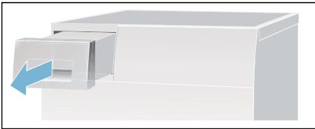
2. Vaciar el agua condensada.
