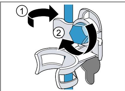
5. Den Schlauch in die Halterung einsetzen.
