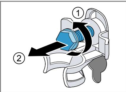
3. Die Netzanschlussleitung aus der Halterung ziehen.
