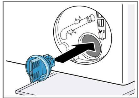
Sicherstellen, dass die Bauteile des Pumpendeckels fest zusammensitzen.
