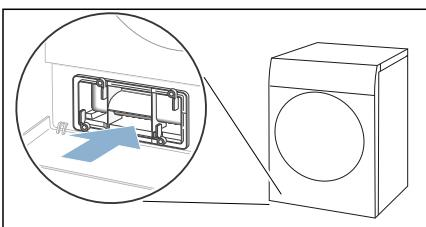
**Anvisning:** Du kan inte skjuta in värmeväxlarskyddet förrän insatsen är i maskinen.
