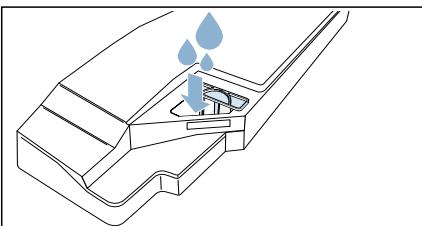
**Anvisning:** Håll kondensattanken horisontellt, så att du inte spiller ut vätskan.
