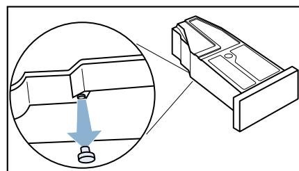
9. Vrid kondensattanken ytterligare 180° och sätt proppen i fördjupningen på ovansidan av kondensattanken.
