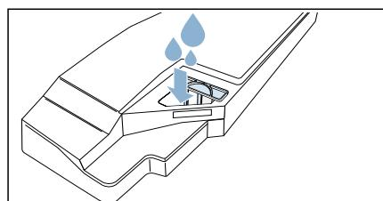
**Anvisning:** Håll kondensattanken horisontellt, så att du inte spiller ut vätskan.
