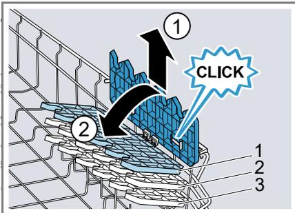
2. Слегка наклоните полку и задвиньте ее на нужную высоту ②.
