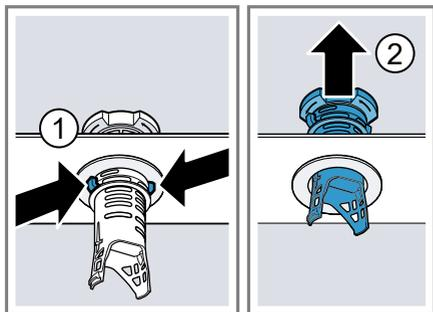
5. Промойте фильтрующие элементы проточной водой.
